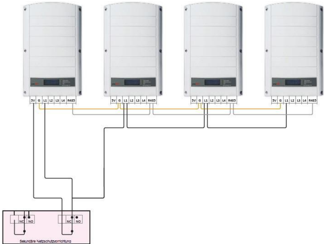
Abbildung 3: Anlage mit mehreren Wechselrichtern, kein RRCR
