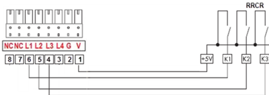
Abbildung 5 – Wechselrichter – FRE Verbindung (mit 3 Relais)
